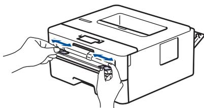
5. Schieben Sie einen Umschlag mit beiden Händen in die manuelle Zufuhr, bis die Oberkante die Papiereinzugsrolle berührt. Wenn Sie spüren, dass das Gerät das Papier einzieht, lassen Sie es los.
