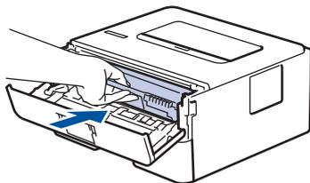
5. Schließen Sie die vordere Abdeckung des Geräts.
