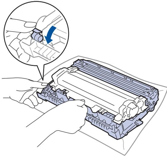
9. Drehen Sie die Trommeleinheit wie in der Abbildung gezeigt. Stellen Sie sicher, dass sich das Zahnrad der Trommeleinheit auf der linken Seite befindet.
