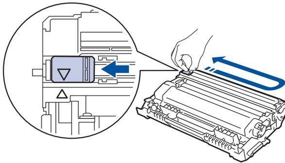
Achten Sie darauf, den Reiter in die Ausgangsposition zurückzuführen (▲). Der Pfeil am Reiter muss am Pfeil an der Trommeleinheit ausgerichtet sein. Andernfalls können auf den gedruckten Seiten vertikale Streifen erscheinen.
