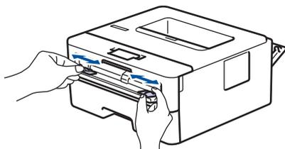
4. Schieben Sie ein Blatt Papier mit beiden Händen in die manuelle Zufuhr, bis die Oberkante die Papiereinzugsrollen berührt. Wenn Sie spüren, dass das Gerät das Papier einzieht, lassen Sie es los.
