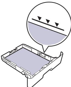
6. Schieben Sie die Papierkassette langsam vollständig in das Gerät ein.
