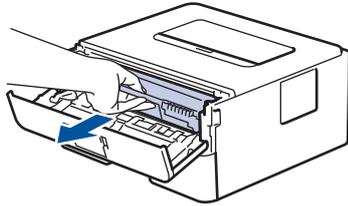
8. Drücken Sie den grünen Verriegelungshebel nach unten, und nehmen Sie die Tonerkassette aus der Trommeleinheit.
