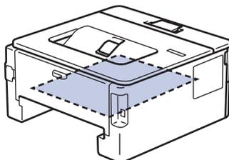
6. Wenn das Papier nicht innerhalb der Kassette für beidseitigen Druck gestaut ist, öffnen Sie die hintere Abdeckung.
