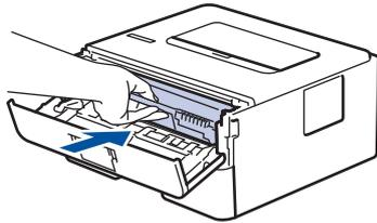
15. Schließen Sie die vordere Abdeckung des Geräts.
