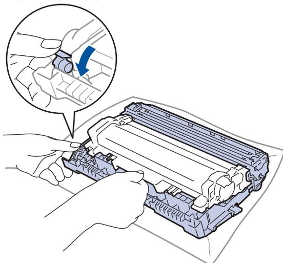
7. Drehen Sie die Trommeleinheit wie in der Abbildung gezeigt. Stellen Sie sicher, dass sich das Zahnrad der Trommeleinheit auf der linken Seite befindet.
