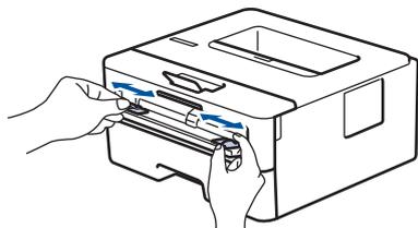
4. Schieben Sie ein Blatt Papier mit beiden Händen in die manuelle Zufuhr, bis die Oberkante die Papiereinzugsrollen berührt. Wenn Sie spüren, dass das Gerät das Papier einzieht, lassen Sie es los.
