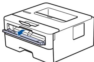
3. Schieben Sie die Papierführungen der manuellen Zufuhr mit beiden Händen auf die Breite des Papiers, das Sie verwenden.
