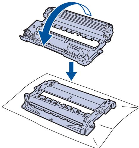
8. Suchen Sie die Stelle auf der Trommel anhand der nummerierten Markierungen neben der Trommelwalze. Zum Beispiel bedeutet ein Punkt in Spalte 2 auf dem Testblatt, dass sich eine Stelle im Trommelbereich „2“ befindet.
