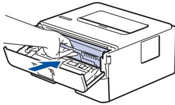
8. Schließen Sie die vordere Abdeckung des Geräts.
