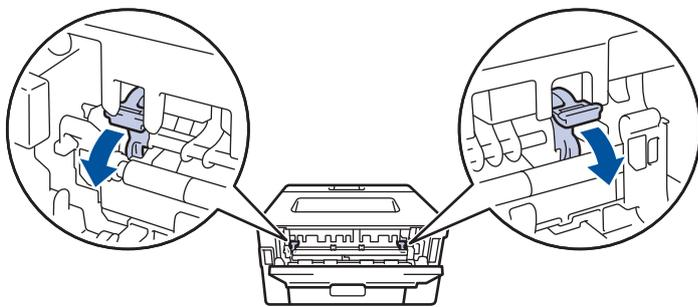
3. Öffnen Sie an der Vorderseite des Geräts die Abdeckung der manuellen Zufuhr.
