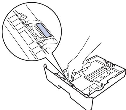
5. Wischen Sie die beiden Aufnahmerollen im Inneren des Geräts ab, um Staub zu entfernen.
