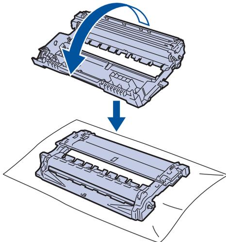
10. Suchen Sie die Stelle auf der Trommel anhand der nummerierten Markierungen neben der Trommelwalze. Zum Beispiel bedeutet ein Punkt in Spalte 2 auf dem Testblatt, dass sich eine Stelle im Trommelbereich „2“ befindet.
