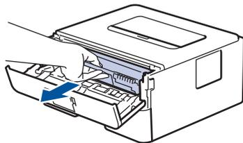
4. Drücken Sie den grünen Verriegelungshebel nach unten, und nehmen Sie die Tonerkassette aus der Trommeleinheit.
