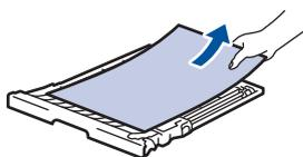
5. Entfernen Sie das Papier, das sich möglicherweise aufgrund der statischen Elektrizität unter dem Gerät gestaut hat.
