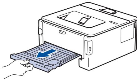
4. Ziehen Sie das gestaute Papier aus dem Gerät oder aus der Kassette für den beidseitigen Druck heraus.
